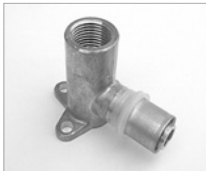
Рис. 45. Отвод фиксируемый обжимной, резьба внутренняя.
