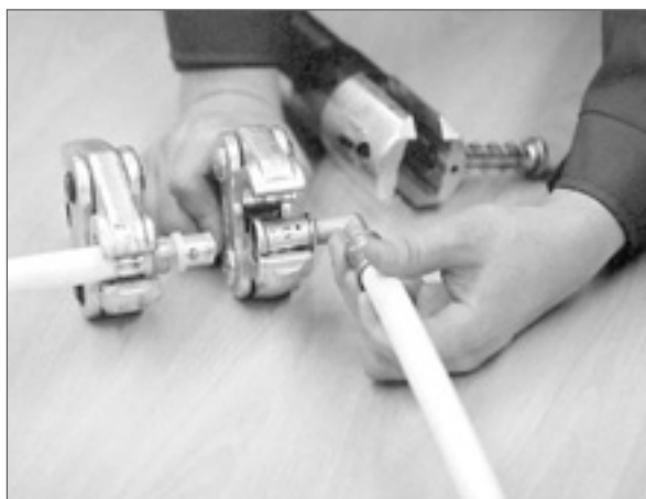
Рис. 46. Способ расположения в щеке кольца с выпуклым основанием и кольца с полимерной насадкой; для соединения применяется щеки типа TH (соотв. Каталогу REMS).
