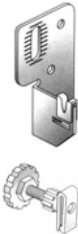
Рис. 92. Типы кронштейнов для отопительных приборов VK, нанесенных на шкале монтажного шаблона.
