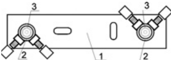
Рис. 241. УЗЕЛ «PPOD-Z18» - две водоразборные точки с ответвлениями на холодную и горячую воду к последующим водоразборным точкам.
